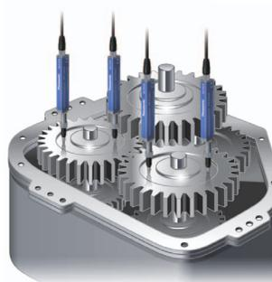
变速器零件的高度测量
