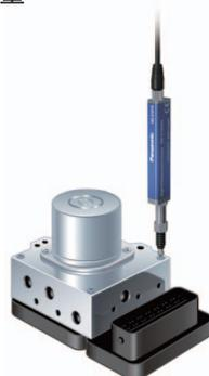
螺钉紧固后的高度测量
