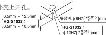
② 将检测头插入外壳上加工的孔中，用附带的安装用螺母轻轻固定。
